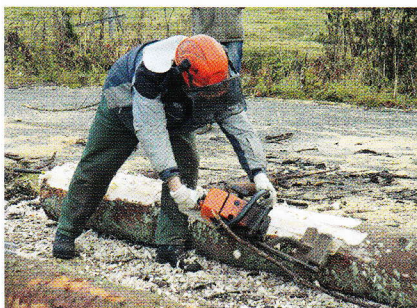
Odkorňování adaptérem na motorovou pilu.
